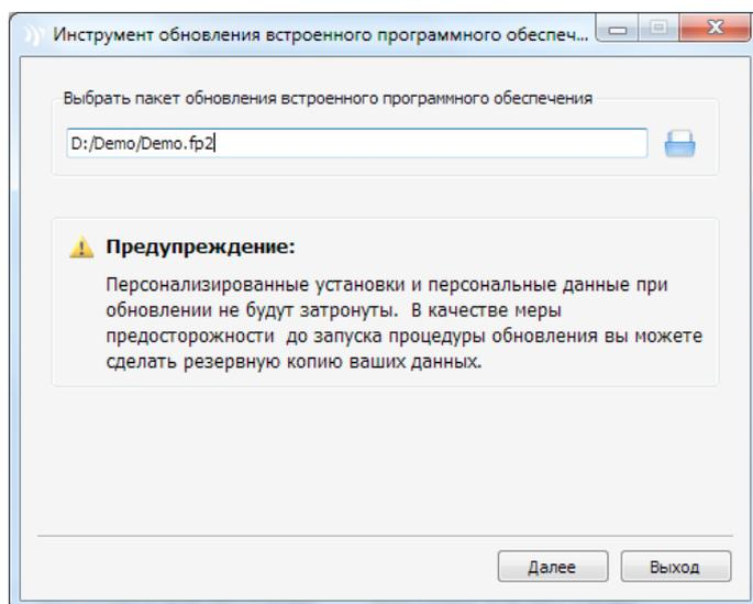
**Примечание:** До запуска инструмента обновления встроенного программного обеспечения убедитесь в том, что ваш телефон не подсоединен к компьютеру.
